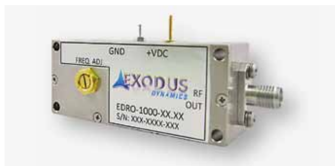
Рис. 34. Сверхмалозащумяющий АГДР фирмы Exodus Dynamics серии EDRO-1000-XX.XX с выходной мощностью 1 Вт на частоте 10 ГГц с TTL системой управления выходной мощностью в пределах 19 дБ (при напряжении -3 В) с питанием 360 мА при 12 В
