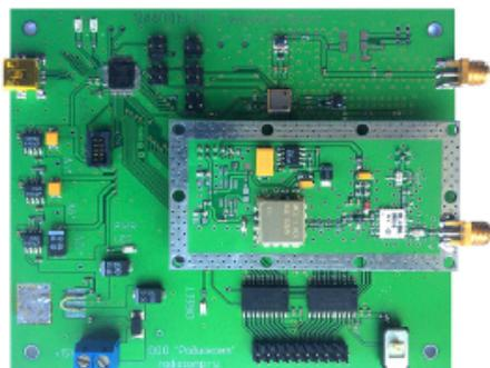
Радиационно-стойкая интегральная микросхема 1288ПЛ1У синтезатора частот на основе ФАПЧ предназначена для использования в синтезаторах несущих и гетеродинных частот, а также в синтезаторах сигналов приемопередающих устройств радиолокационных и связных комплексов в VHF, UHF, L, P, S и C диапазонах.
