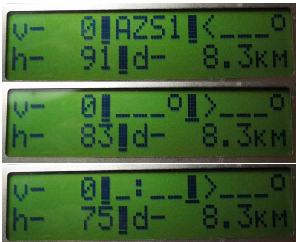
Рис. 11. Виды экрана на штурманской странице при снижении скорости < 3 км/ч (модель НС-2).
