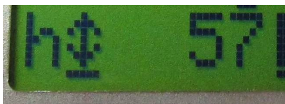
Рис. 7. Разница между текущей и «захваченной» высотой.
