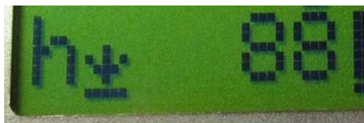
Рис. 6. Значок «захвата» высоты
