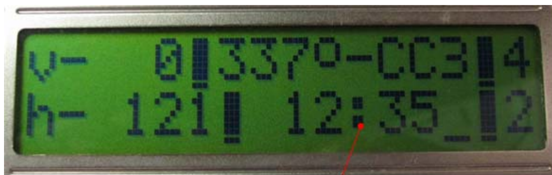
Рис. 8. Вид экрана в режиме вывода времени (модель НС-2).
