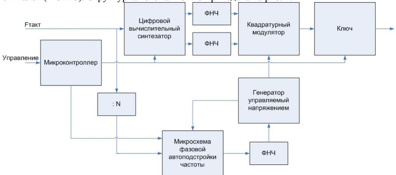
Рис. 1. Структурная схема ФСШС.
